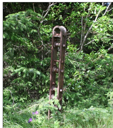
Mynd 34. Kraftstaur með strekki rúllum við tóft Sauðahúsa (260-45).
